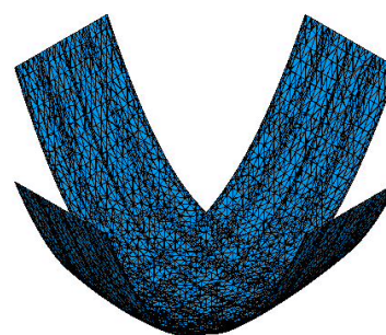
Fig. 6. Voalura parașutei principale deformată sub efectul presiunii dinamice.
